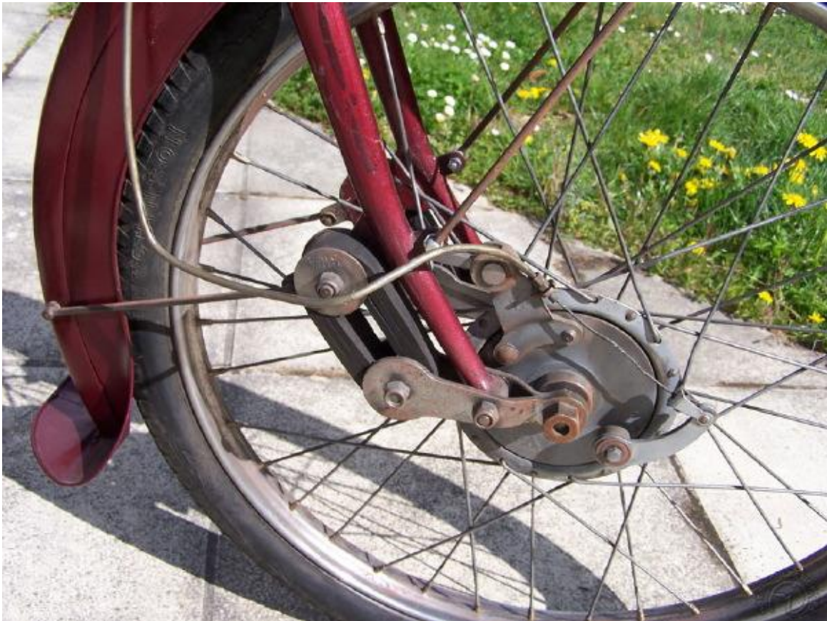
Le tandem pouvait recevoir en option la suspension à roue poussée et anneaux
