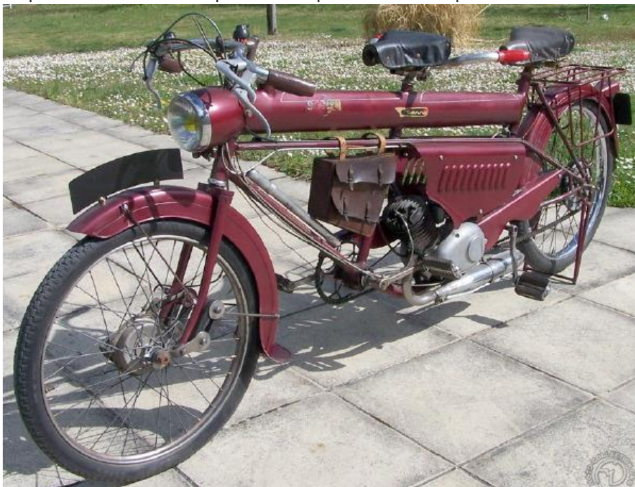
Le tandem pouvait recevoir en option la suspension à roue poussée et anneaux
